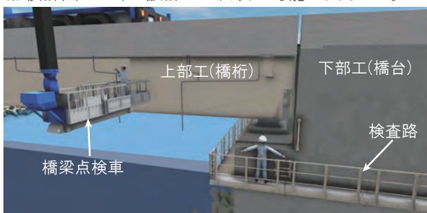
図4 BIM/CIMによる点検経路検討
