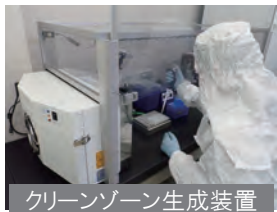
クリーンゾーン生成装置
