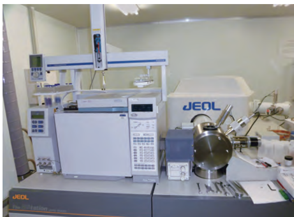
写真4 PCB測定装置(高分解能ガスクロマトグラフ質量分析計)
