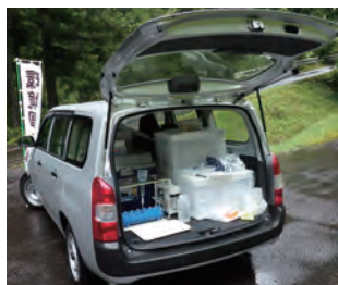
写真1 現場ろ過システムの積載例
