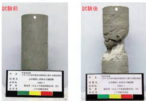
写真3 液状化試験前と試験後の供試体
