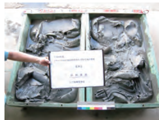
写真1 採取した浚渫土
