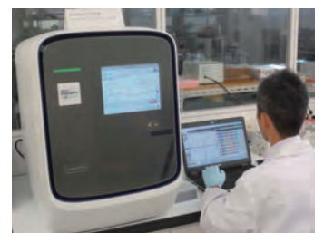
写真1 蛍光リアルタイムPCR装置によるDNA測定
