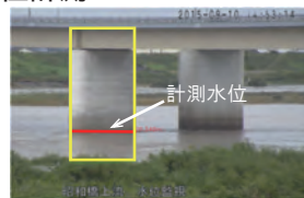
図5 画像例(昭和橋)
