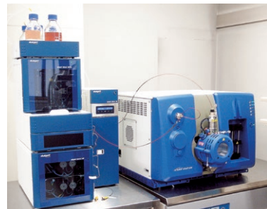
生体試料分析に使用される高速液体クロマトグラフ・タンデム型質量分析計
