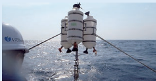
ボトムトリガーを取り付けた大型採水器
