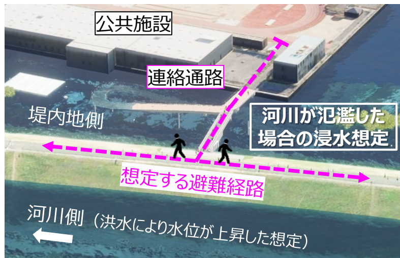
水害時の浸水想定や河川堤防と公共施設を繋ぐ連絡通路の防災機能をわかりやすく説明
