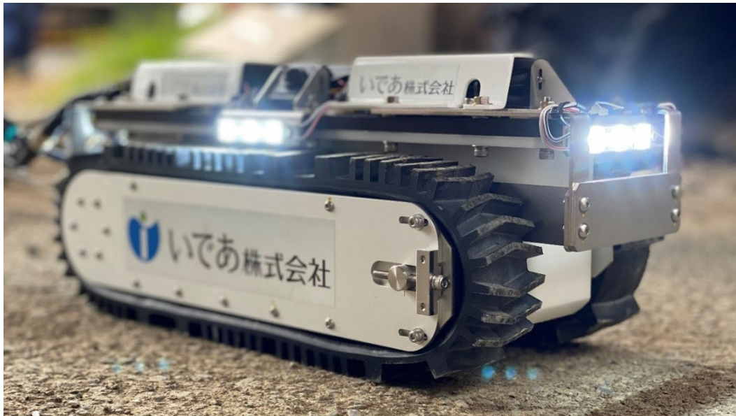
点検ロボット
